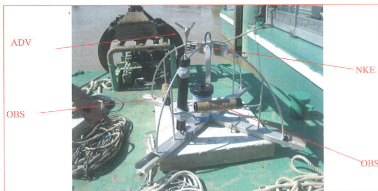
Figure 11 : structure en forme d'igloo sur laquelle les instruments décrits ci-dessus sont installés. Le tout est installé sur un bloc de béton d'un poids de 300 kg. L'ensemble est relié à un autre bloc de béton équipé d'un flotteur signalant la présence des instruments dans le fond de la Garonne.
