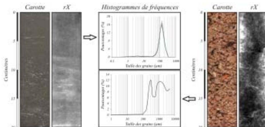
Figure IV-7. Caractérisation des faciès sableux (gauche) et sablo-graveleux (droite).
