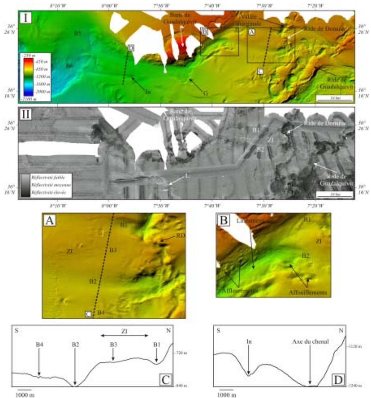
Figure III-14. Physiographie du chenal de Guadalquivir. I : bathymétrie EM300 ; II : imagerie EM300 ; A-B : détails bathymétriques ; C-D : profils bathymétriques ; B1, B2, B3, B4, B5 : branches du chenal ; G : glissement ; In : incision ; L : limite de réflectivité ; RD : ride de Donana ; ZI : zone inter-écoulements.
