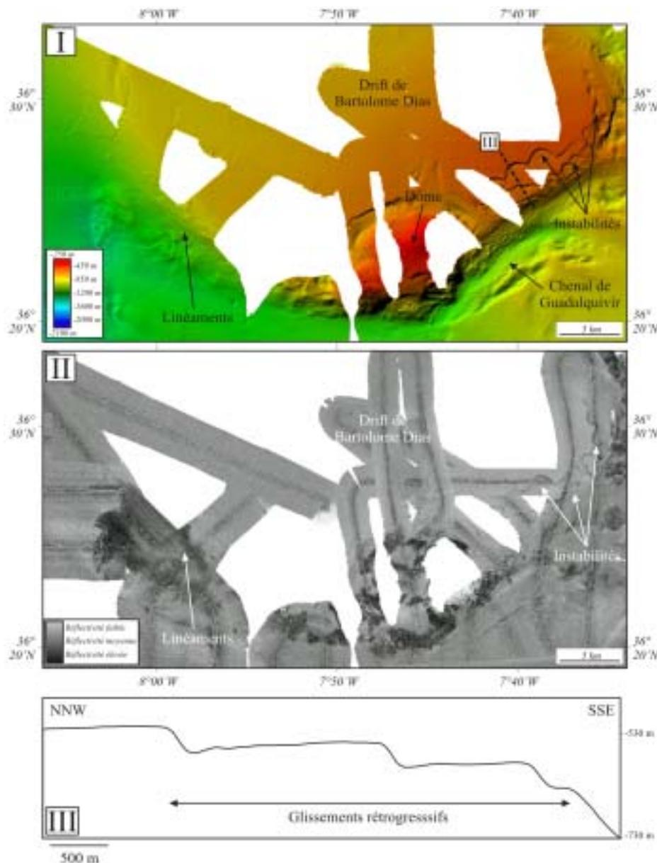
Figure III-23. Physiographie du banc du Guadalquivir et du drift de Bartolome Dias. I : bathymétrie EM300 ; II : imagerie EM300 ; III : profil bathymétrique.
