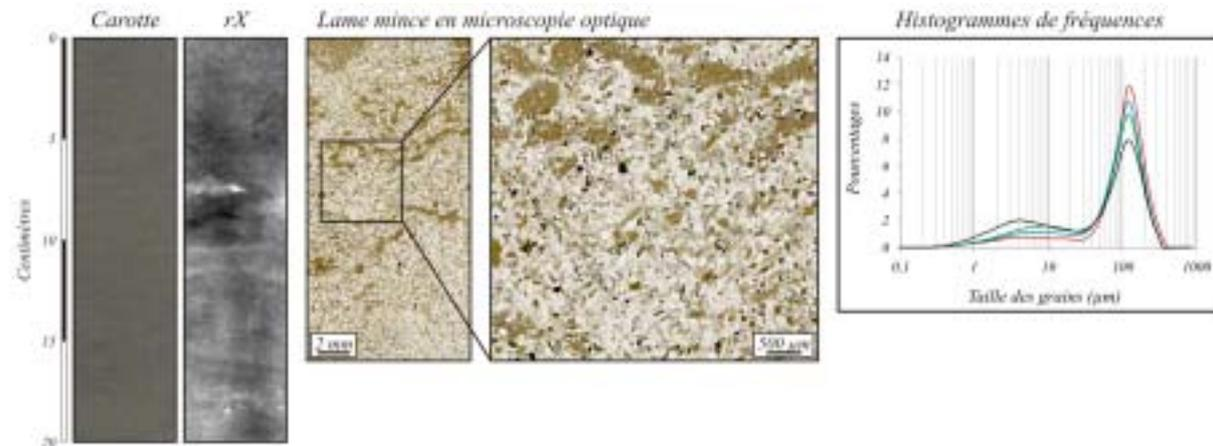
Figure IV-6. Caractérisation à différentes échelles du faciès sablo-silteux.
